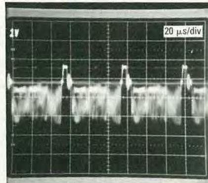
FIG. 16—INVERTED VIDEO AT IC1, pin 6.
