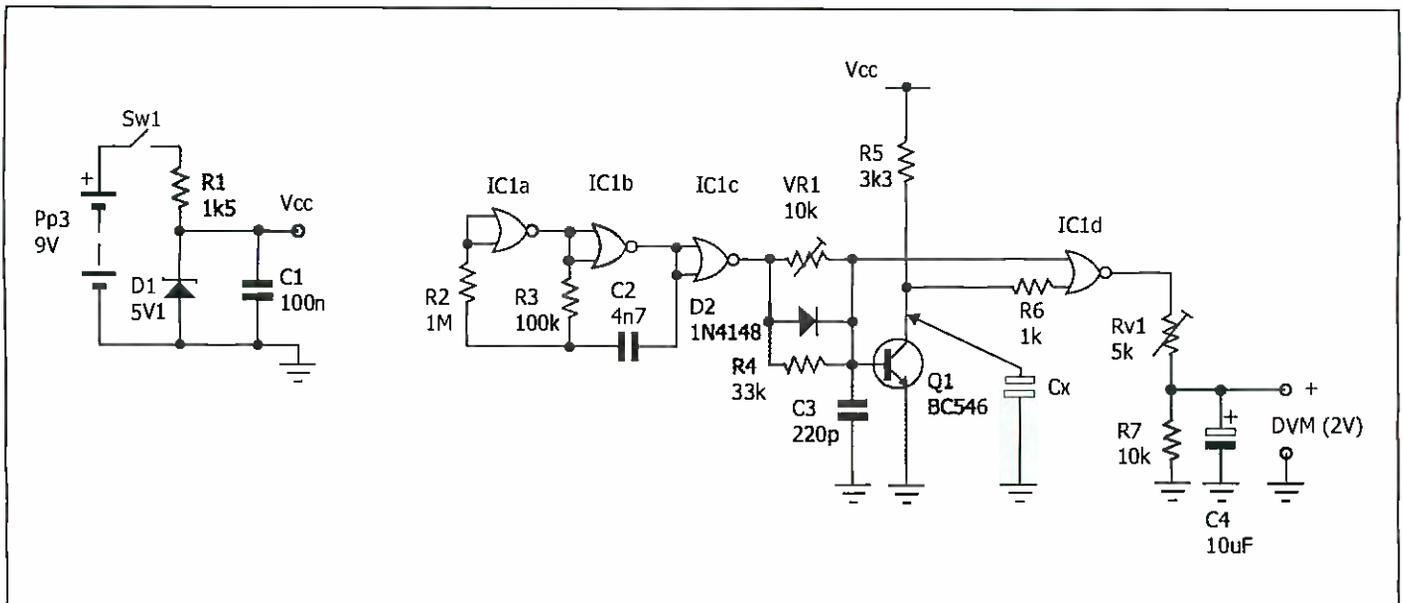
**THIS CIRCUIT IS FOR A VERY SIMPLE CAPACITANCE METER. CALIBRATION IS PROVIDED TO TRIM OUT THE STRAY CAPACITANCE SO THAT IT CAN MEASURE SMALL VALUES.**
