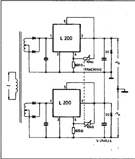
COMPENSATION OF VOLTAGE DROP ALONG THE WIRES
