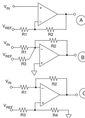
$$V_{OUT} = \left(1 + \frac{R2}{R1}\right) \cdot V_{IN} - \frac{R2}{R1} \cdot V_{REF}$$
