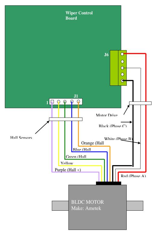
Figure 29. Ametek Motor Wiring Guide
