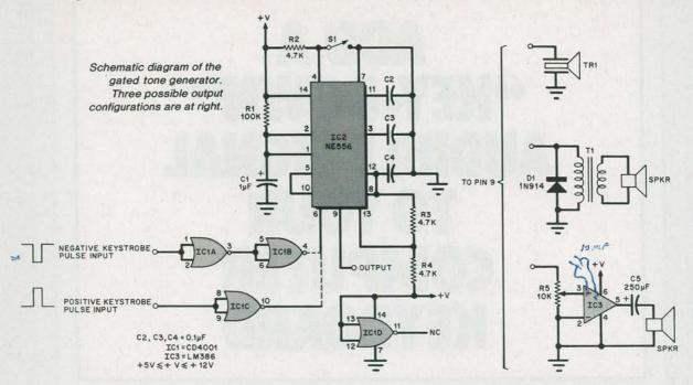
C1—1-µF, 25-volt electrolytic C2, C3, C4—0.1-µF disc ceramic capacitor / 2.%/ C5—250-µF, 25-volt electrolytic D1\*—1N914 signal diode
