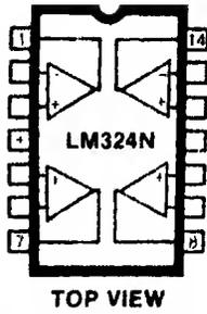
Fig. 4: Pin configuration of IC LM324
