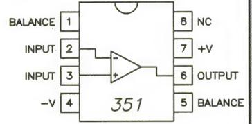
Fig 5 IC pinouts
