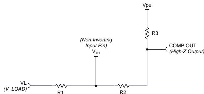
$$V_{TH} = V_L \times \left( \frac{R_2 + R_3}{R_1 + R_2 + R_3} \right) + V_{PU} \times \left( \frac{R_1}{R_1 + R_2 + R_3} \right)$$
